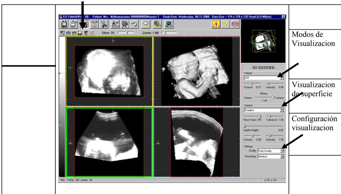
Tenemos diferentes modos de visualización Así para visualizar regiones con una gran reflexión al los ultrasonidos se utilizan modo Maximum Intensity Projection. En cambio el modo Minimum Intensity Projection nos permite visualizar las regiones con poco reflexión a los ultrasonidos como puede ser líquidos y/o quistes. También es posible trabajar en un modo de visualización similar a las imágenes de rayos X
